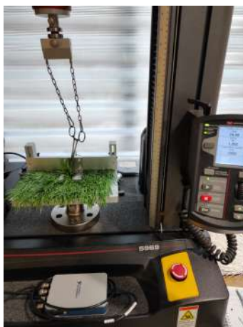
Figura 5.2: Ensayo de césped artificial
