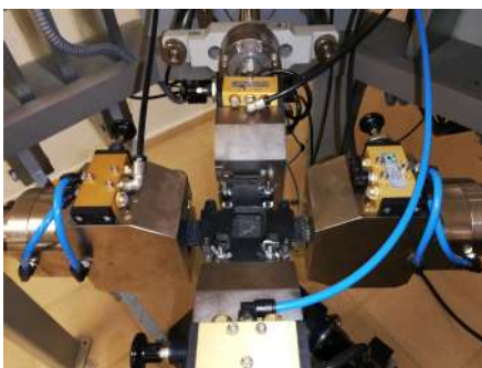
(a) Dispositivo antipandeo instalado
