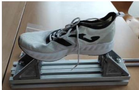
Figura 5.3: Montaje del ensayo de flexión de zapatilla deportiva.
